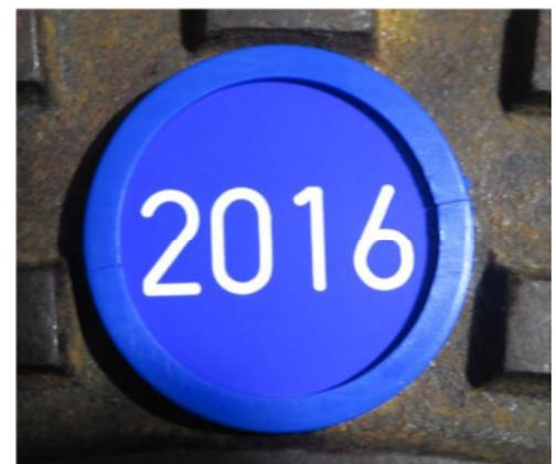
Das **IN - Formation - System** besteht aus einem geteilten Stopfen, der nach dem Einbringen einer Kennzeichnungsscheibe / Chip zusammen gesteckt wird. Anschließend wird der Stopfen in die Lüftungsöffnung (D= 37 mm) des Schachtdeckels eingeschlagen.
